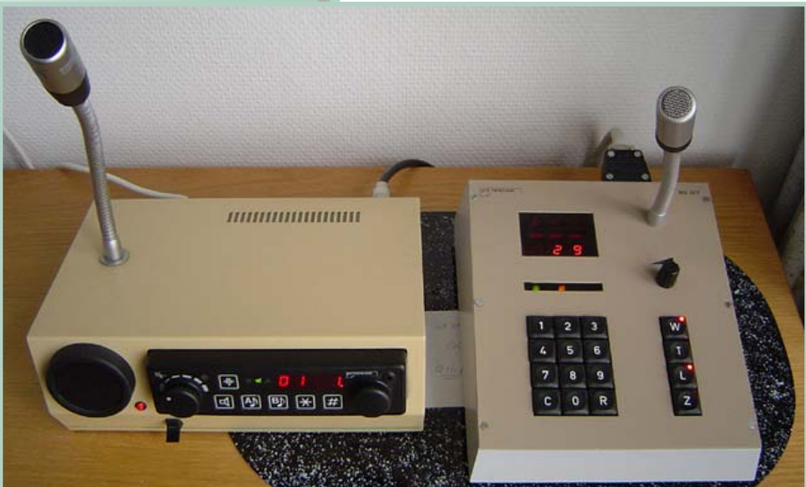
De basispost thuis. Met de Condor 16 mobilfoon en rechts de bedieningseenheid voor het invoeren en uitzenden van de tooncode (Foto: Bas van Heezik)
